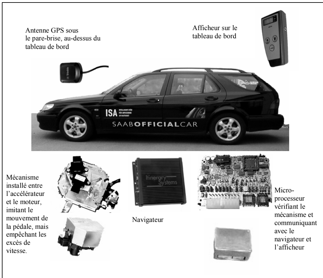
Figure 10.7. Éléments d'un accélérateur sensitif ISA sur un prototype (Suède)
