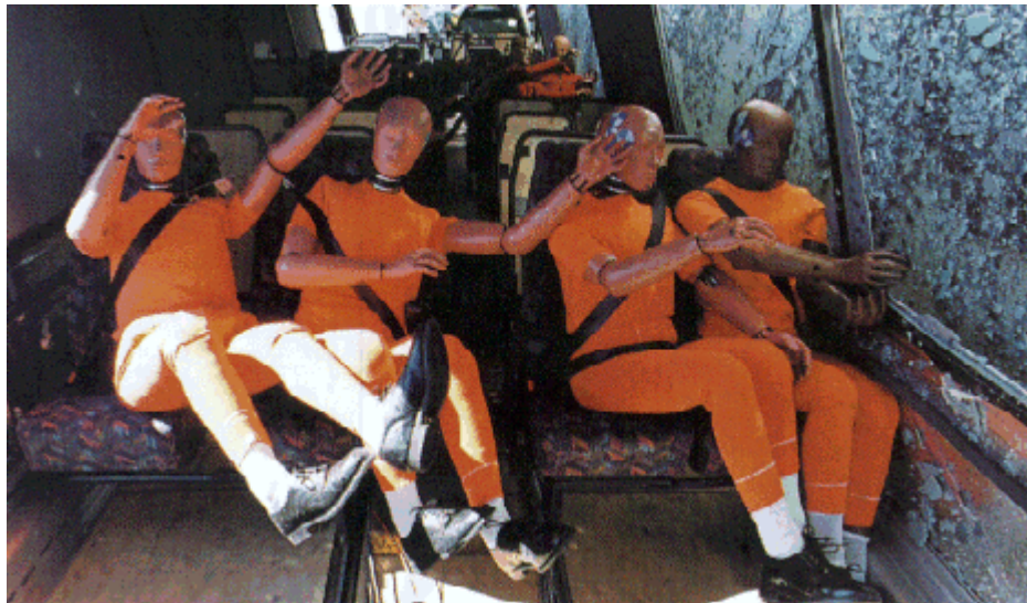
Figure 13. Illustration de l'efficacité de la ceinture de sécurité à trois points au cours d'un essai de capotage latéral d'autobus
