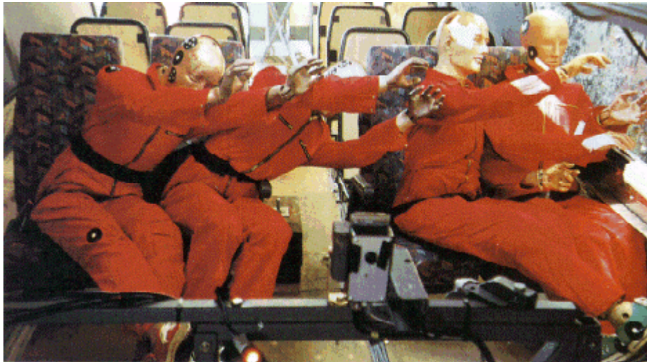
Figure 12. Illustration de l'efficacité de la ceinture de sécurité à deux points au cours d'un essai de capotage latéral d'autobus
