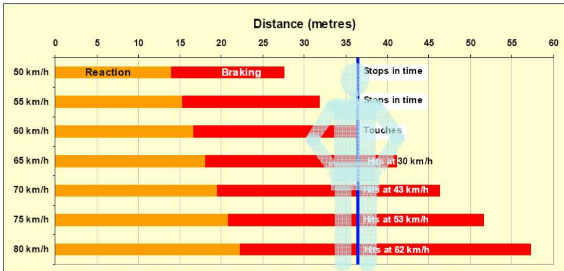
Figura 1. Distancia de frenado a distintas velocidades (incluyendo un tiempo de reacción de aproximadamente 1 segundo)
